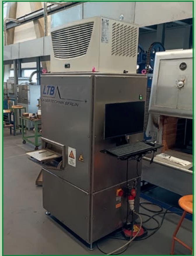
Bild 2: Laser-Induziertes Breakdown Spektroskopie (LIBS)-Messsystem zur Messung schmelzflüssiger Proben
