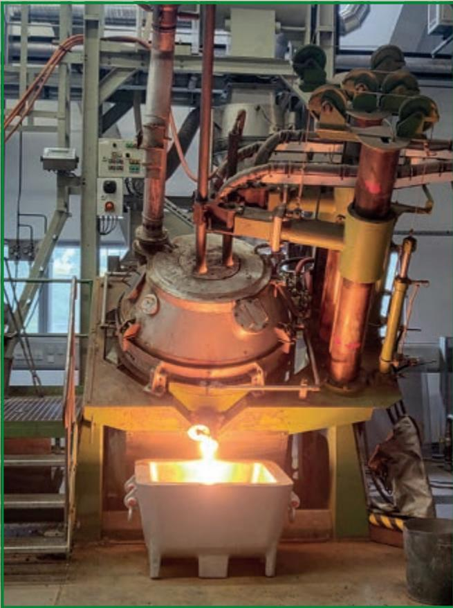
Bild 1: Abguss der reduzierten LDS im kleintechnischen Lichtbogenofen der BAM
