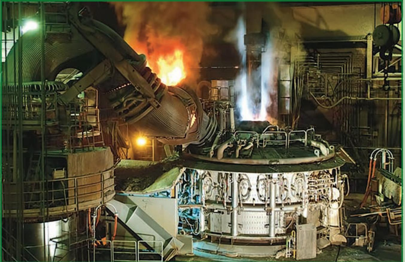
Bild 1: Elektroöfen für die schrottbasierte Stahlherstellung
