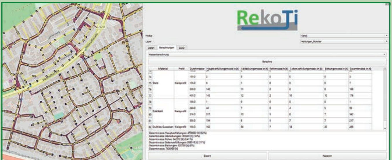
Bild 2: Prototypische Darstellung der GIS-basierten Bestimmung des anthropogenen Materiallagers für die Kanalhaltungen mit der RekoTi-Toolbox
