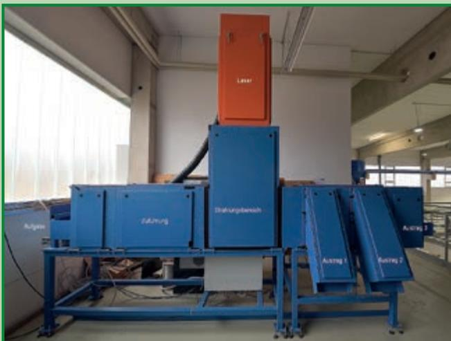
Bild 2: LIBS-Demonstrator am IAB
