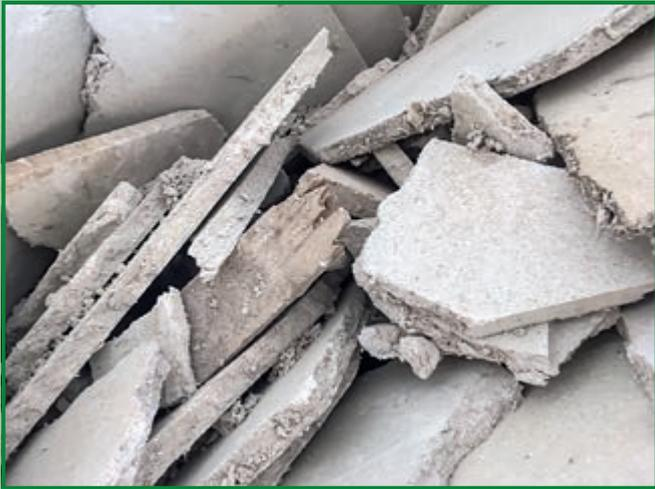
Bild 1: Gipsfaserplatten-Ausgangsmaterial
