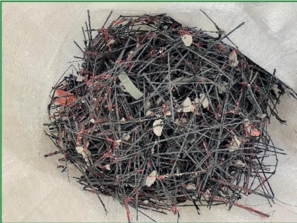
Bild 1: CF aus unterschiedlichen Ursprungsproben mit teils noch anhaftendem Bauschutt
