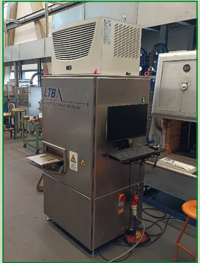
Bild 2: Laser-Induziertes Breakdown Spektroskopie (LIBS)-Messsystem zur Messung schmelzflüssiger Proben Quelle: LTB
