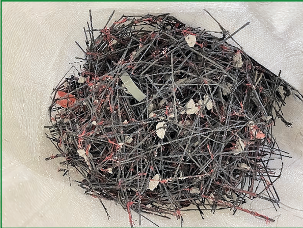
Bild 1: CF aus unterschiedlichen Ursprungsproben mit teils noch anhaftendem Bauschutt Quelle: Mitsubishi Chemical Advanced Materials GmbH
