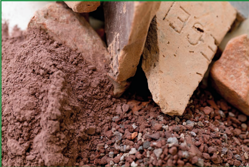
Bild 1: Ziegelhaltige Recyclingbaustoffe aus unterschiedlichen Aufbereitungsstufen: als Ausgangsstoff, als Recyclingbrechsand und als Recyclingmehl Quelle: VDZ Technology gGmbH/ Julia Vogel
