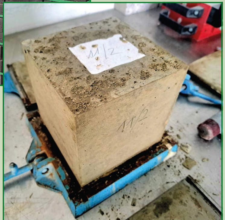
Bild 1: Beim Projektpartner bvw industriell gefertigte Pflastersteine mit LD- Schlacke als Substitut für Gesteins- körnungen aus Sand/Kies Quelle: Sebastian Dittrich, Fraunhofer IBP
