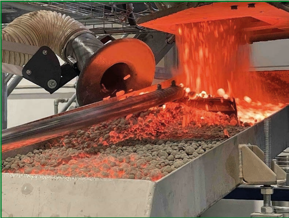
Bild 1: Leichtgranulate am Ofen- auslass des Drehrohrofens Foto: IAB Weimar gGmbH
