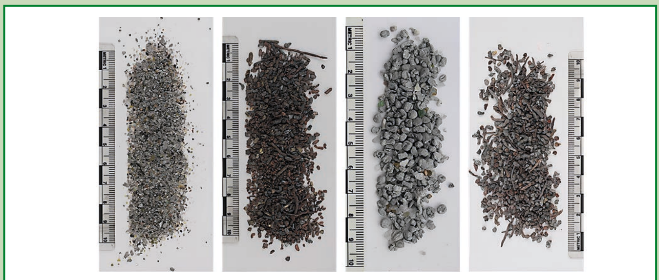
Bild 3: Unterschiedliche zurückgewonnene NE-Metall-Fractionen Quelle: Ida Adhiwiguna, Universität Duisburg-Essen
