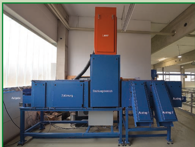
Bild 2: LIBS-Demonstrator am IAB Quelle: Müller (IAB Weimar)
