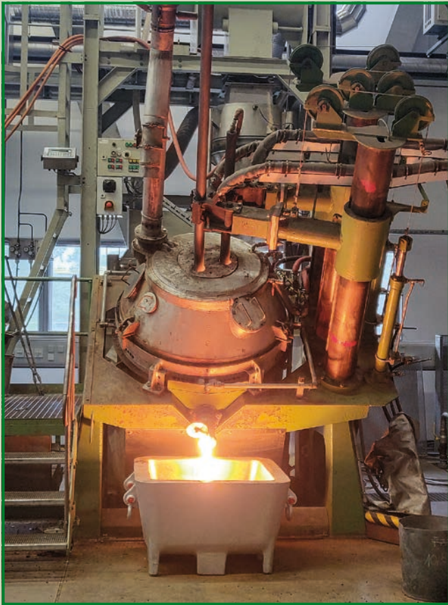
Bild 1: Abguss der reduzierten LDS im kleintechnischen Lichtbogenofen der BAM Quelle: BAM
