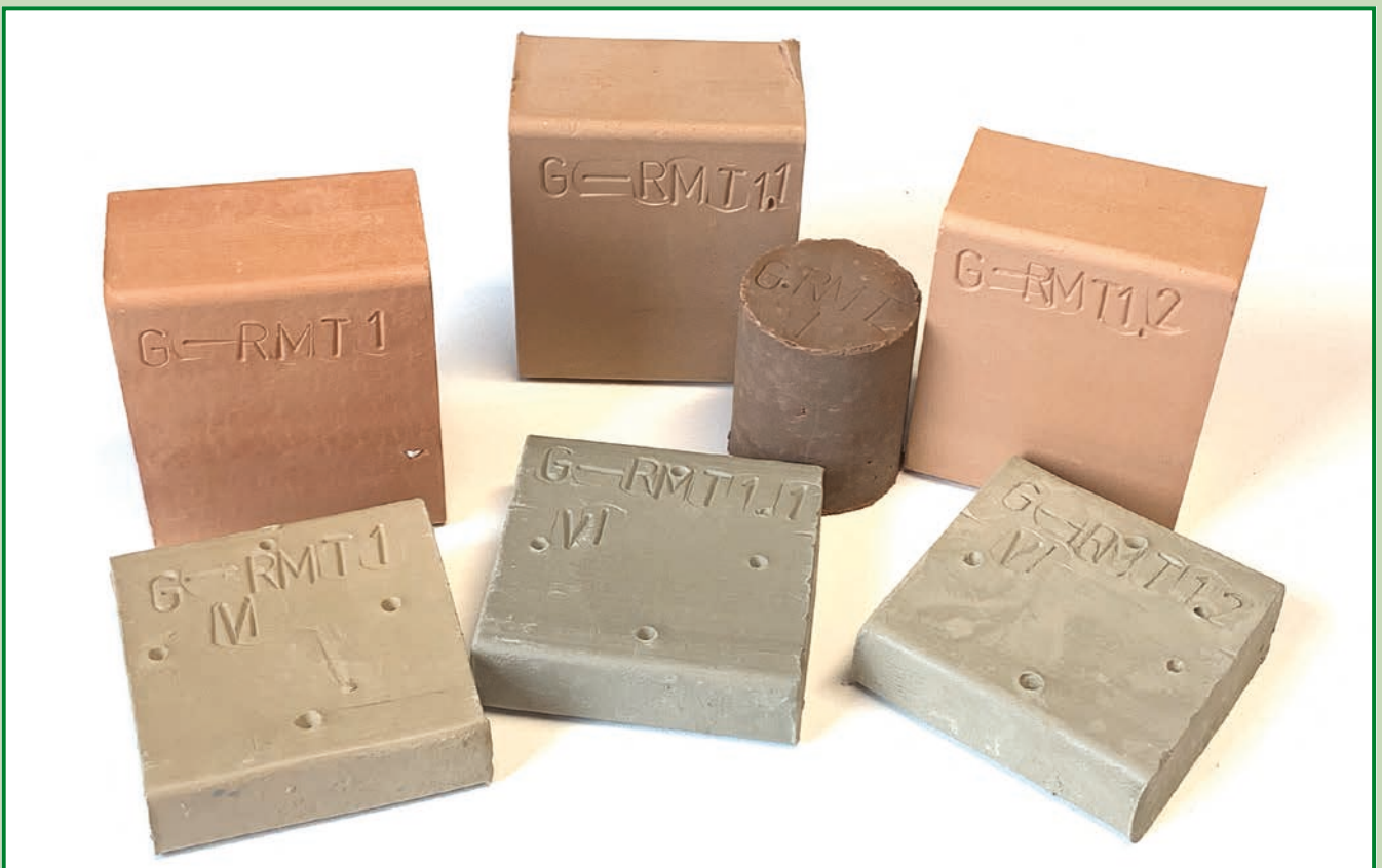
Bild 2: Keramikproben aus aufbereiteter Mineralik-Fraktion: RMT1 Referenzprobe; RMT 1.1 und 1.2 mit je 15 % REMINTA-Material Quelle: Geiger, Felix von Aulock
