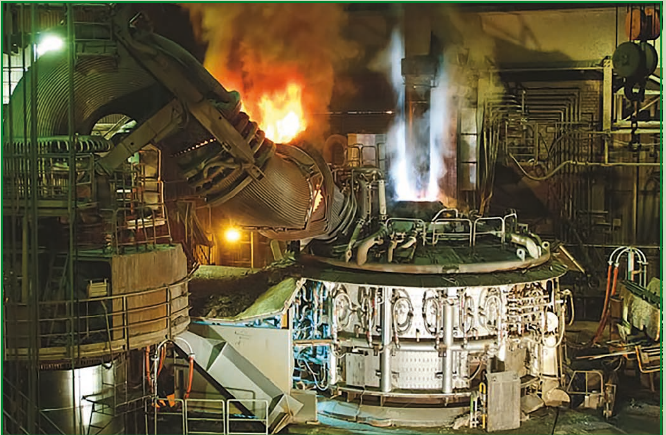
Bild 1: Elektroofen für die schrottbasierte Stahlherstellung Quelle: Georgsmarienhütte
