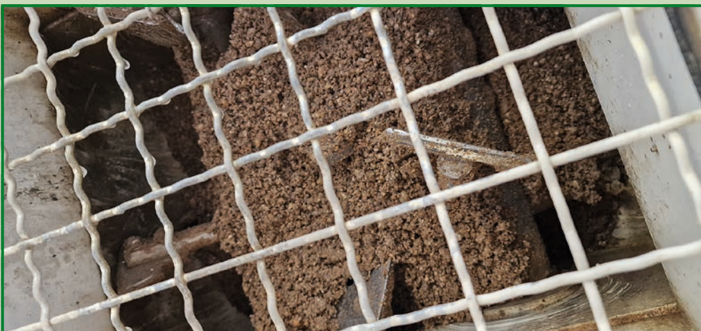
Bild 3: Betonmischung mit MVR im Werk der Fertigbeton Rheinland GmbH & Co. KG Quelle: Daniel Wulff-Janssen, TH Köln
