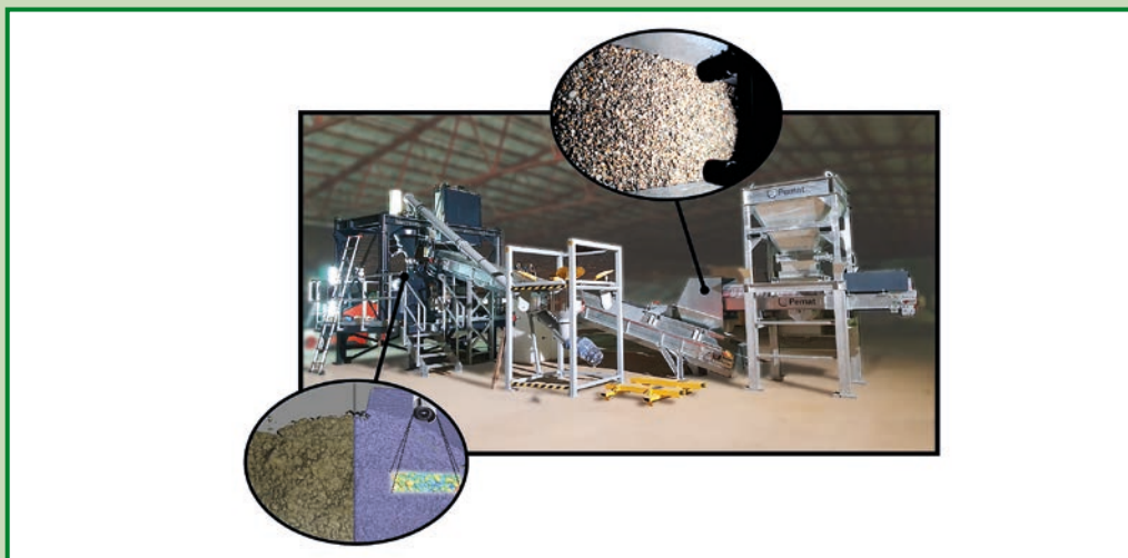
Bild 2: Sensorgestützte Pilotmisch- anlage im Technikum der Leibniz Universität Hannover Quelle: Institut für Baustoffe
