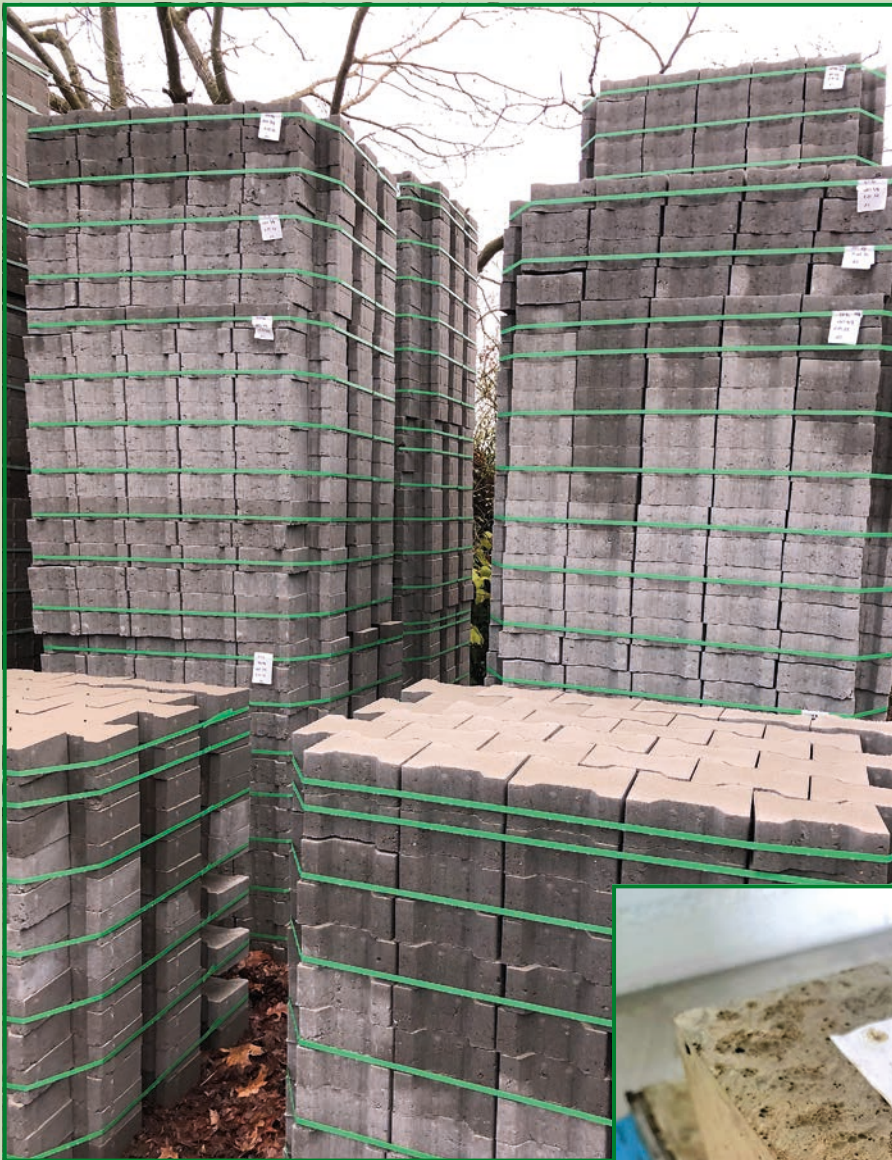
Bild 1: Beim Projektpartner bvw industriell gefertigte Pflastersteine mit LD- Schlacke als Substitut für Gesteins- körnungen aus Sand/Kies Quelle: Sebastian Dittrich, Fraunhofer IBP
