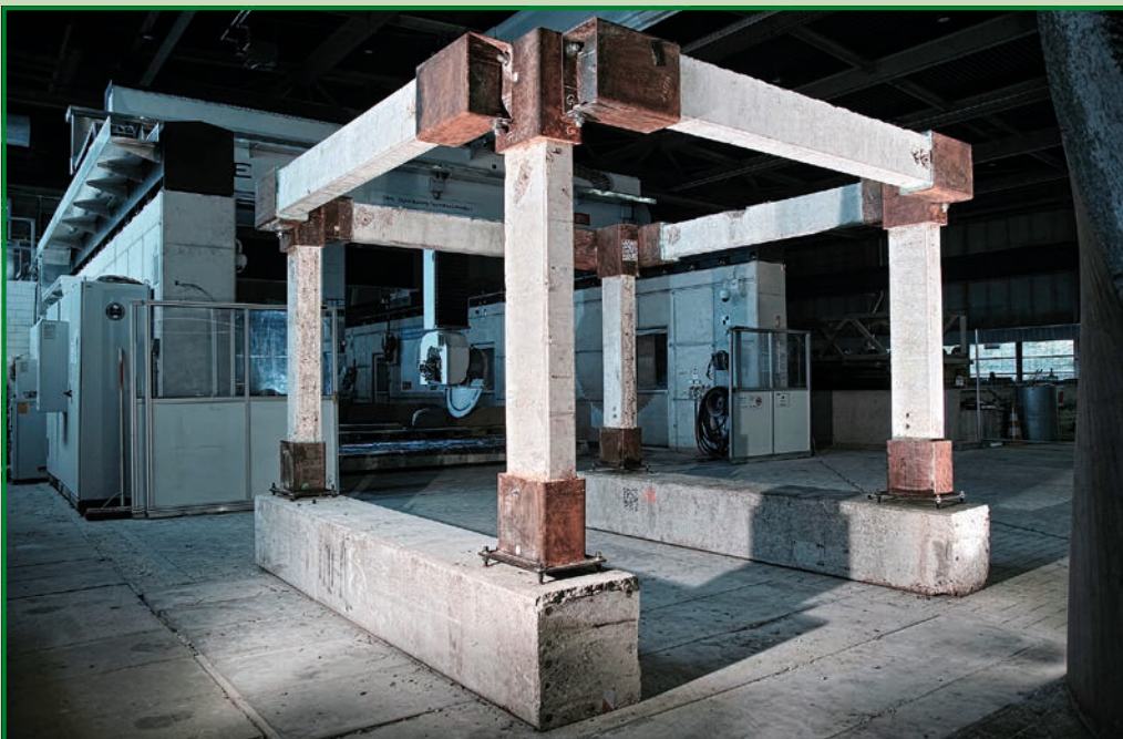
Bild 2: Zusammengebauter 1:1-Demonstrator aus wiederaufbereiteten, modularen Fertigteilen 2.0. Quelle: Lukas Ledderose, ITE, TU Darmstadt
