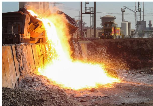
Im Projekt BAUSEP wird an der Separation von Aschen und Schlacken für die Herstellung ressourceneffizienter Bauprodukte geforscht. Das Bild zeigt das Abgießen einer Schlacke.
