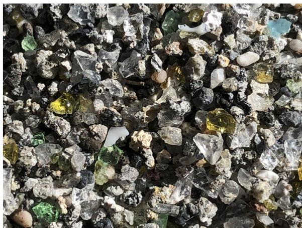
Ziel ist es geeignete Aschen und Schlacken so aufzubereiten, dass sie als Ersatz für Primärgesteinskörnungen eingesetzt werden können. Das Bild zeigt eine solche aufbereitete Müllverbrennungsasche.
