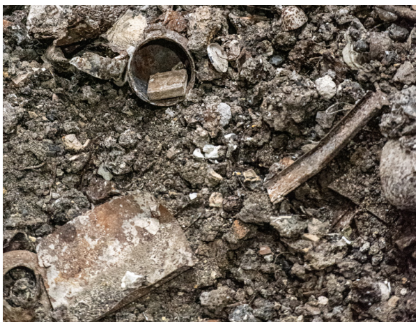
Schlacken aus der Müllverbrennung: EMSARZEM bearbeitet diese Schlacken als Rohstoff für die Zementindustrie auf.
