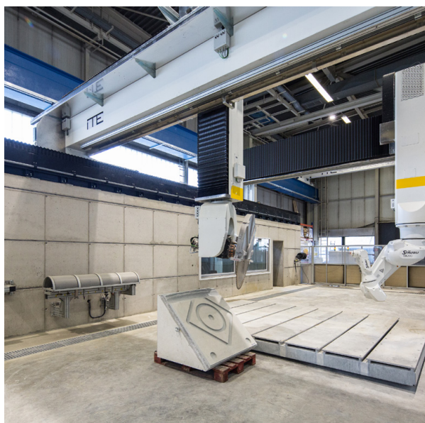
Digital Building Fabrication Laboratory (DBFL) am ITE der TU Braunschweig mit zwei Bearbeitungseinheiten zur subtraktiven, robotischen Bearbeitung von Betonbauteilen.
