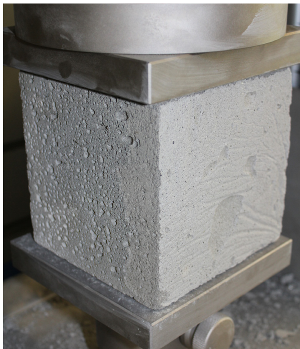
Druckversuch an Würfeln aus Mineralschaum
