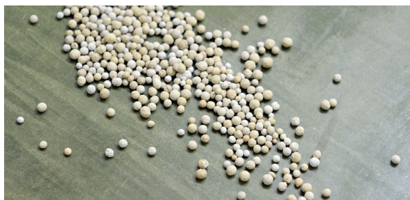
Ziel des Projekts REALight ist die Herstellung von Leichtgranulaten aus mineralischen Bau- und Abbruchabfällen.
