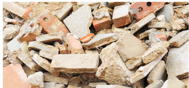
Ein Ausgangsstoff: Bauschutt mit heterogener Zusammensetzung
