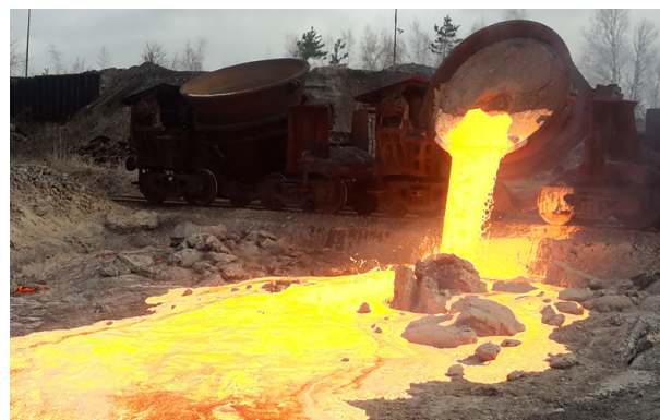
Entleerung von Schlackepfannen im Stahlwerk.
